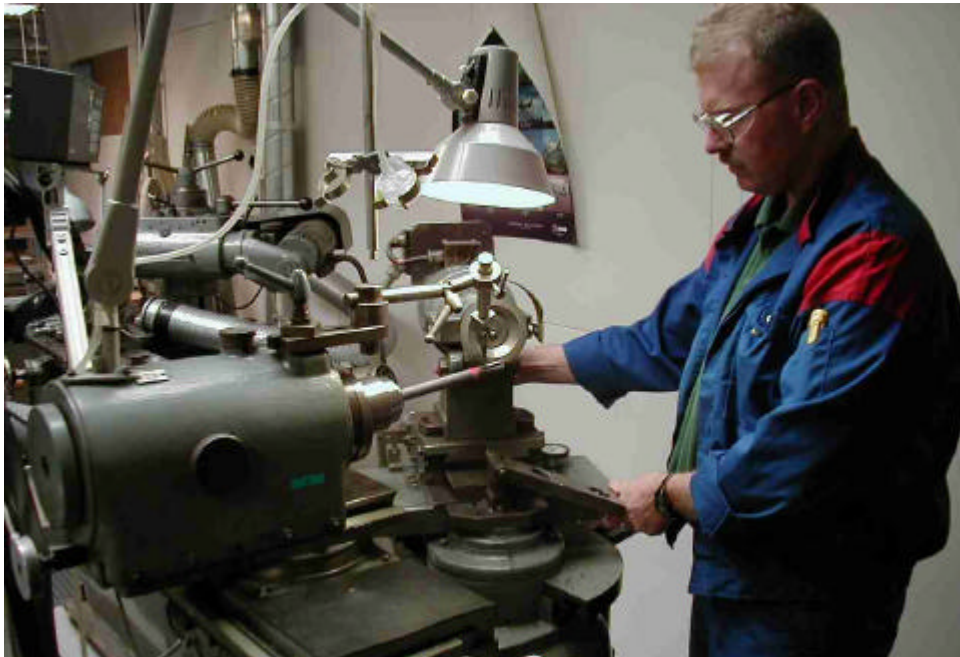
Bild 1. Arbetsstation före förbättring där slipdamm sprids i andningszonen
