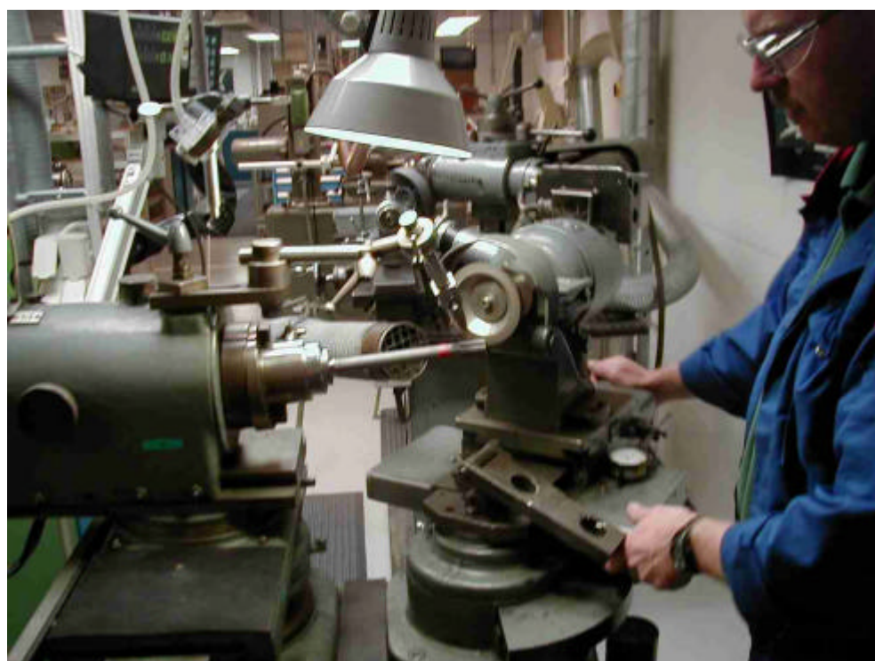
Bild 2. Arbetsstation efter förbättring så att slipdammet inte sprids direkt i andningszonen
