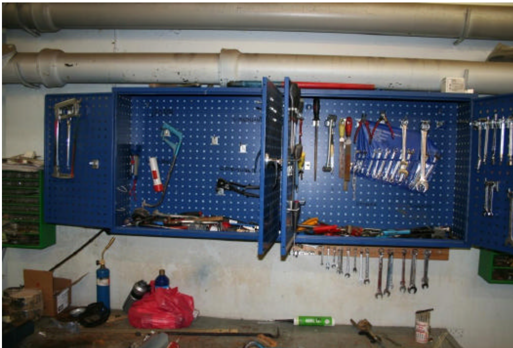
Bild 4. Förutsättningar för ordning och reda existerade, men utnyttjades inte fullt ut. En mängd verktyg ligger på botten i verktygsskåpet istället för att hänga på avsedda platser.
