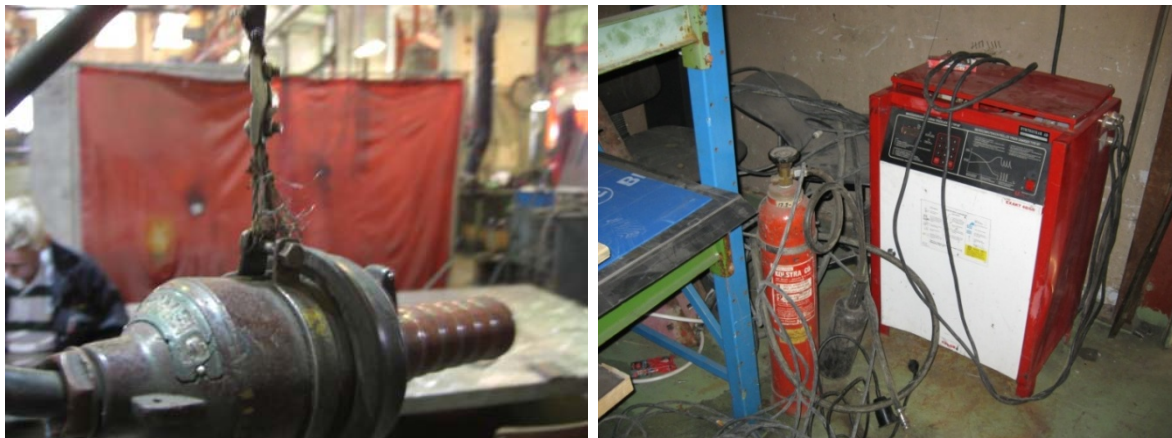
Figur 5. Exempel på fotograferade risker. Bilden till vänster visar ett trasigt vajerfäste och bilden till höger visar en olämplig placering av brandsläckare.
