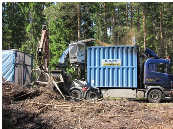
Figur 9. Sönderdelning av brun GROT, ca 1 år, med lastbilshugg på Scania R620. Föraren sitter i hytten vid flisbaljan när han kör kranen.
