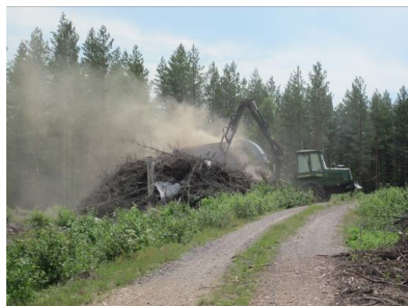
Figur 8. Sönderdelning av GROT vid torr och varm väderlek.. Bilden till vänster visar sönderdelning av färsk grön GROT med John Deere 1510E och bilden till höger ca 3 år gammal brun GROT med John Deere 1410D.
