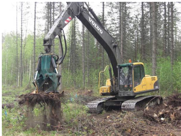
Figur 11. Skördning av stubb med grävmaskin. Till vänster en Volvo EC210LC med skördningsaggregat Karelia Tech X-Power och till höger en Daewoo 225LCV med skördningsaggregat Martini.
