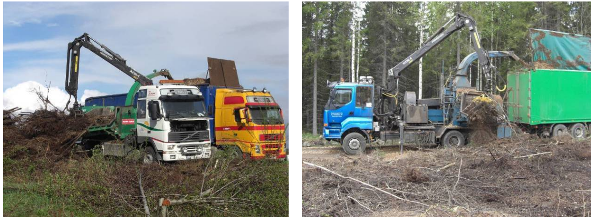
Figur 4. Sönderdelning av GROT med lastbil. Till vänster en Volvo FH12 med hugg Jenz Hem 560 och till höger en SISU 18E630 med hugg Heinola Sawmill Machinery.
