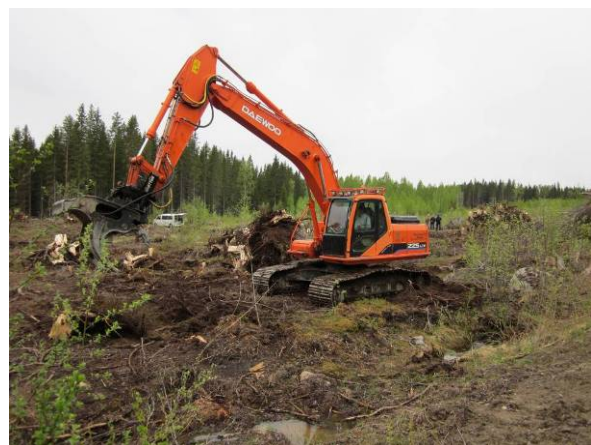
Figur 11. Skördning av stubb med grävmaskin. Till vänster en Volvo EC210LC med skördningsaggregat Karelia Tech X-Power och till höger en Daewoo 225LCV med skördningsaggregat Martini.
