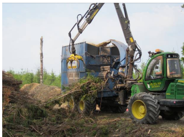
Figur 8. Sönderdelning av GROT vid torr och varm väderlek.. Bilden till vänster visar sönderdelning av färsk grön GROT med John Deere 1510E och bilden till höger ca 3 år gammal brun GROT med John Deere 1410D.
