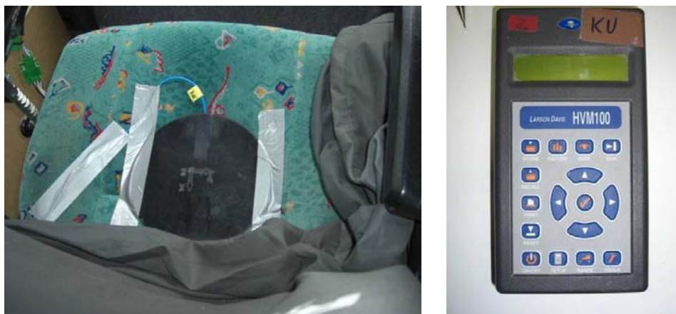
Figur 2. Vänstra fotot visar sittaccelerometern och högra fotot vibrationsmätaren som användes vid vibrationsmätningarna.
